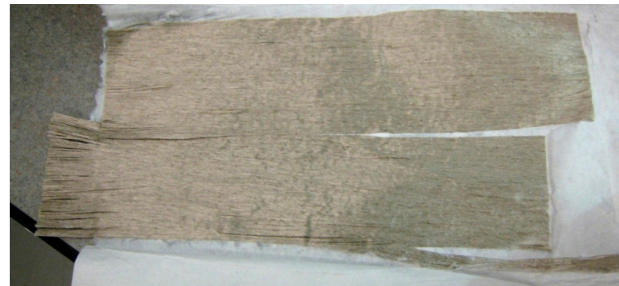
Preuve de concept: renfort lin UD-papier 6"x12" sur machine pilote
